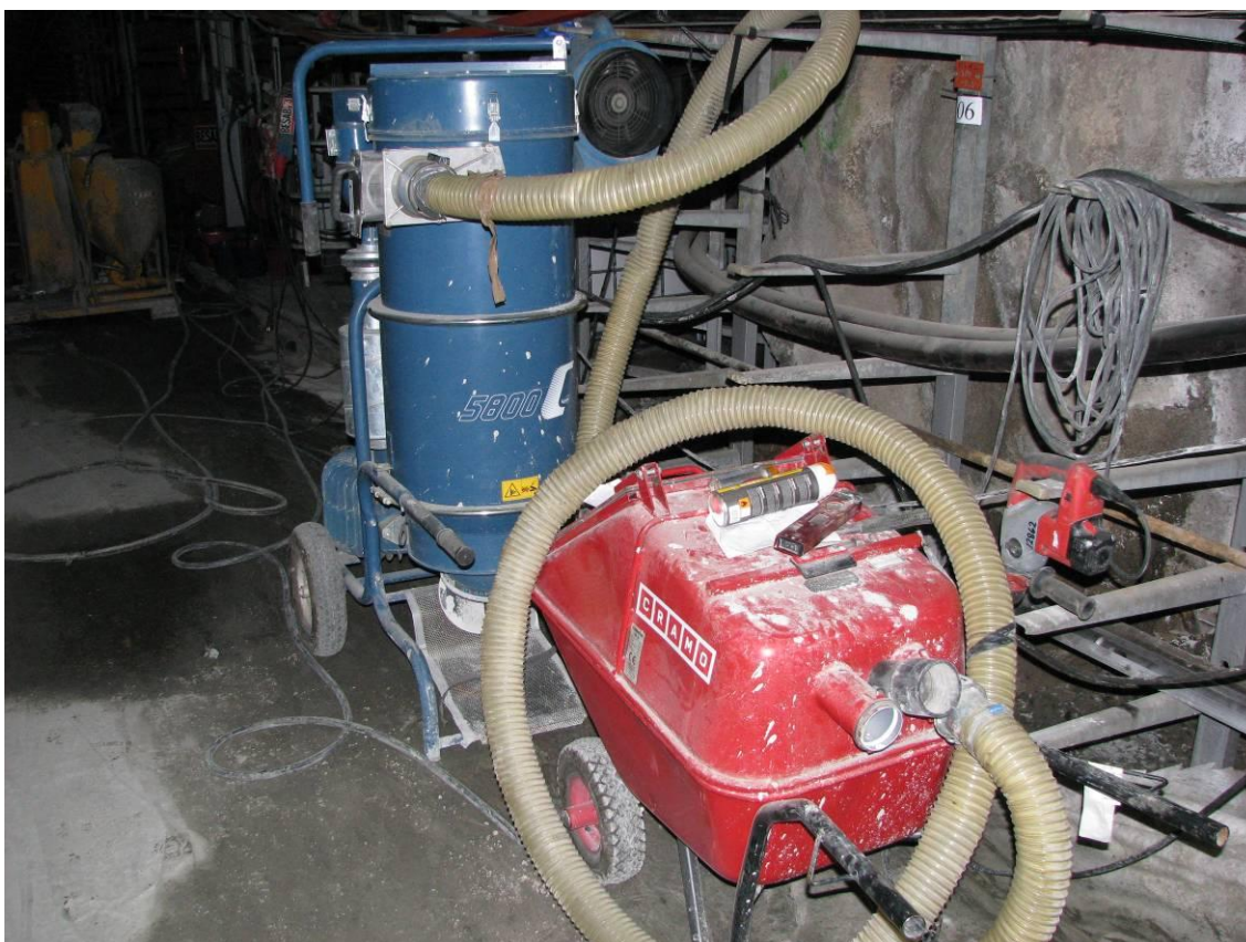
Figur 4-4 Dammsugare med stoftavskiljare som kopplas till bormaskinen.
